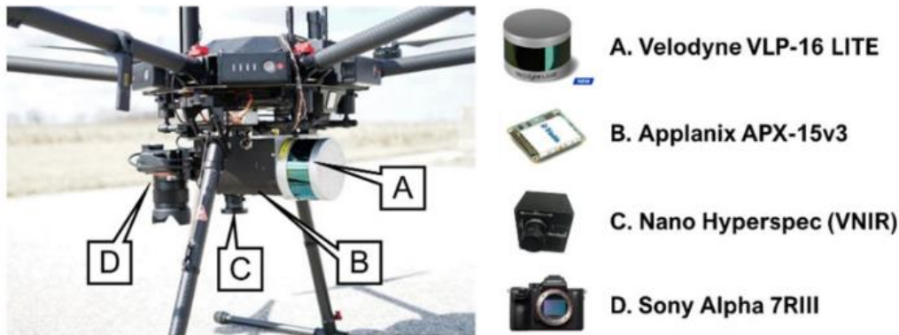
32. attēls. DJI Matrice 600 drons, aprīkots ar Velodyne lidar, Hyperspektrālo kameru, redzamās gaismas RGB kameru un pozicionēšanas sensoru Applanix (Lin et al. 2021).
