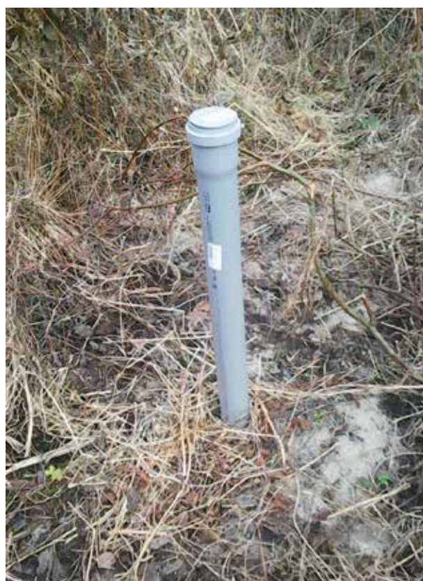
Ierīkots piezometrs gruntsūdens līmeņu mērīšanai, gruntsūdens līmeņu svārstību monitoringam.
