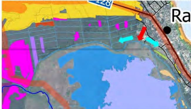
1.att. Slocenes apvadkanāla likvidācijas principiālā shēma, pārrāvums ar sarkanu, ūdens plūsmas virziens ar gaiši zilu
