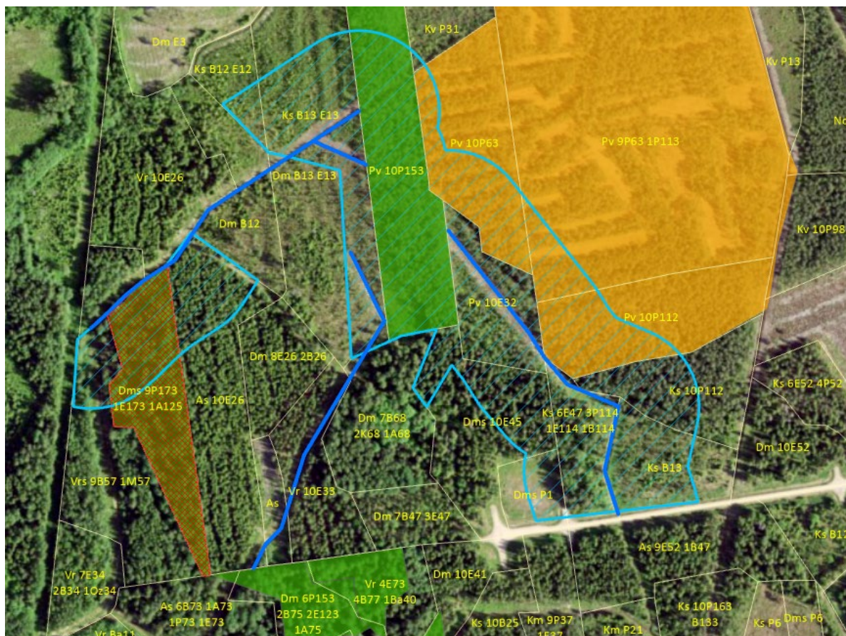
2.1. attēls. Grāvju pārtīrīšanas ietekmes noteikšanas piemērs (biotopu teritorijā saglabājušies nepārtīrītie grāvju posmi, kas ir gandrīz aizauguši; ārpus biotopu teritorijas grāvji pārtīrīti līdz 1,5 m dziļumam). Apzīmējumi: oranžs – purvu biotopi, zaļš – mežu biotopi, sarkani šrafēts – ĪA sugu dzīvotnes, tumši zils – pārtīrītie grāvju posmi, gaiši zils – susināšanas ietekmes zona (80 m no grāvja).
