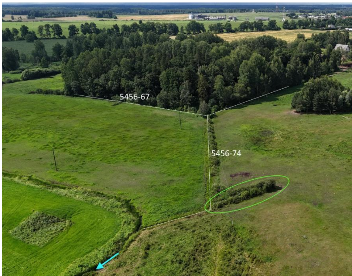
14. attēls. Novadgrāvja 5456-75 novietojums dabā (apzīmēts ar baltām līnijām), kā arī meliorācijas kadastrā neregistrēts grāvis (apvilīts ar zaļu ovālu). Ar gaiši zilu bultu norādīts Eiķenupes plūsmas virziens.
