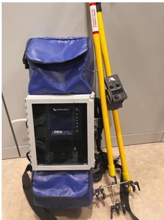
2.1. attēls. Vides DNS ievākšanas iekārta Smith-Root eDNA sampler backpack
