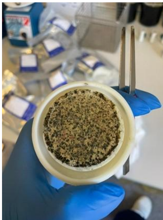
2.5. attēls. Analizēšanai nederīgs (sapelējis) filtrs
