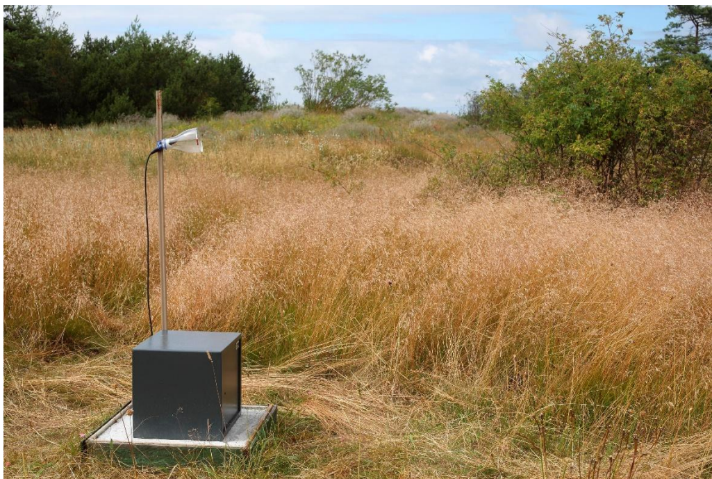
2. attēls Automātiskais detektors D-500 novietots metāla seifā. Detektoram pievienots ārējais mikrofons, kuru no lietus aizsargā plastmasas konuss.
