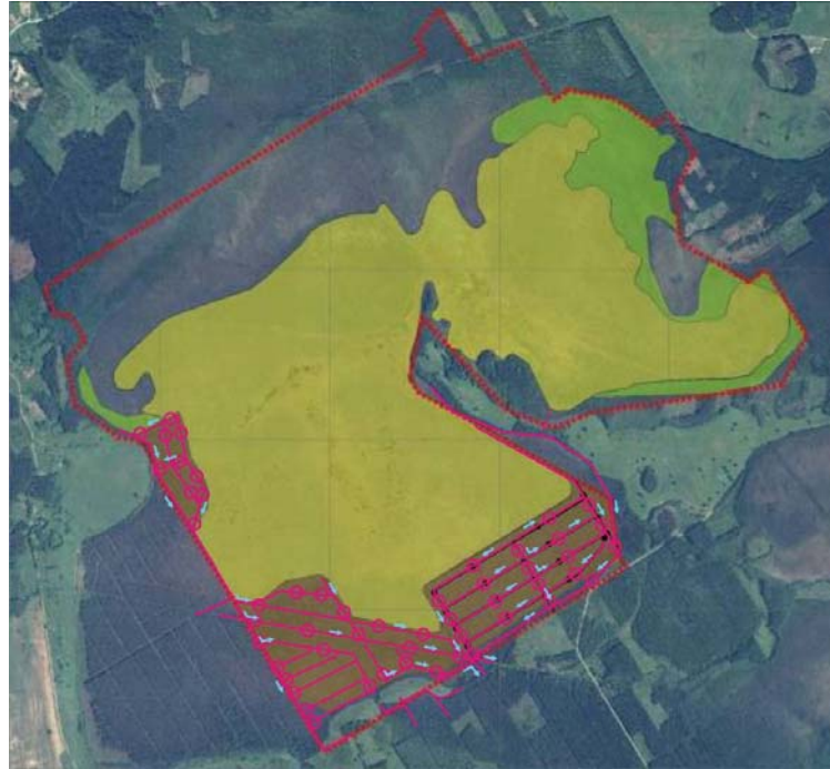
37. attēls. Galvenie purvu susinošie grāvji (—), ūdens plūsmas virzieni tajos (→) un orientējošās dambju vietas (○)
