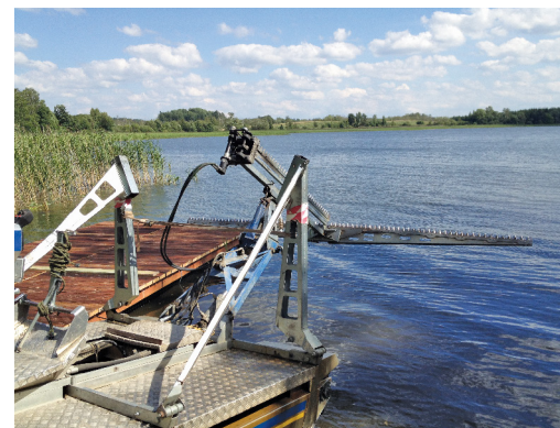
13.8. att. Amfibijas tipa agregāts TRUXOR aprīkots ar plaujmašīnu ūdensaugu izplaušanai. Foto: L. Urtāne.
