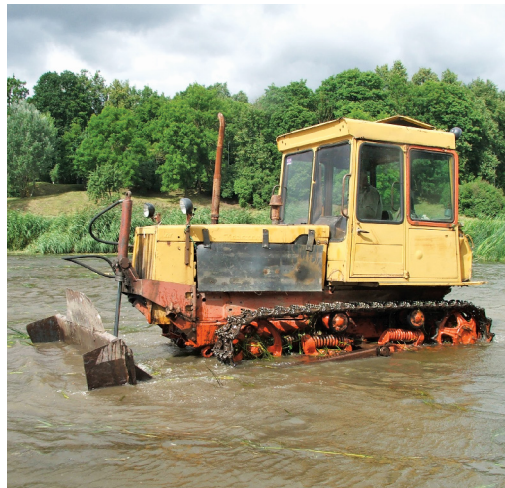
17.29. att. Ūdensaugu aizauguma samazināšanai Mūsā tiek izmantots kāpurķēžu traktors. Foto: A. V. Urtāns.
