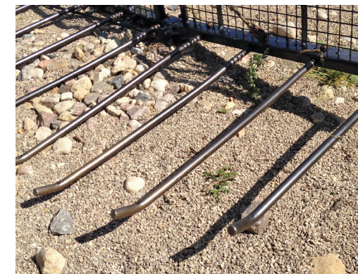
13.9. att. Amfibijas tipa agregātam TRUXOR piemontējama palīgierīce – dakša, kuru izmanto izplautās ūdensaugu masas izceļšanai krastā. Foto: L. Urtāne.
