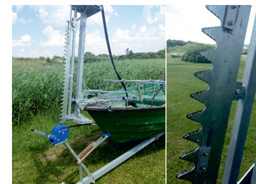
17.27. att. Ūdensaugu plaušanai izmanto arī pie laivas piestiprinātu izkapti. Šāds aprīkojums visbiežāk tiek izmantots ezeros, bet tas ir izmantojams arī lielajās upēs.
