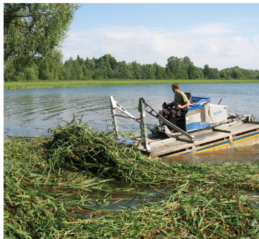
13.10.att. Noplauto niedru izvākšana no ezera ar TRUXOR amfibijai piemontētu dakšu. Foto: L. Urtāne.
