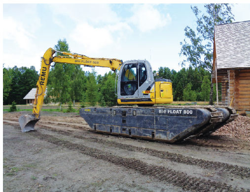
13.6. att. Ar ūdens augiem blīvi aizaugušo teritoriju apsaimniekošanai piemērots ir ambībijas tipa ekskavators Big Float. Foto: J. Reiħmanis.
