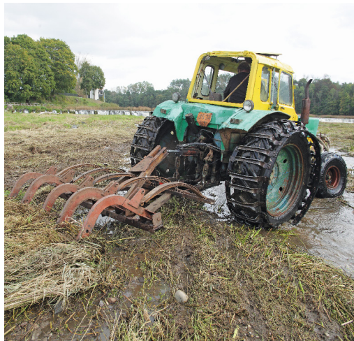
17.28. att. Ūdensaugu aizauguma samazināšanai Ventā tiek izmantots riteņtraktors, kura riteņi, lai nodrošinātu papildu saķeri, ir aprīkoti ar metāla aplikām. Foto: A. Lācis.
