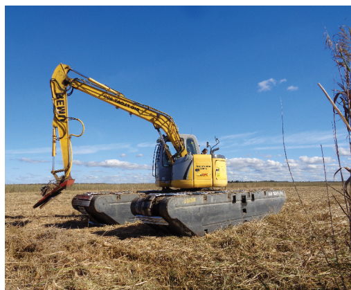
13.5. att. Piekrastes niedru sliksņu fragmentācija Engures ezerā, izmantojot specializētu frēzi. Foto: J. Reiħmanis.
