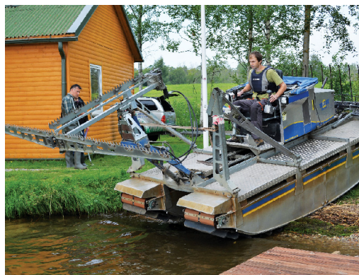
13.7. att. Amfibijas tipa agregāts TRUXOR, kuru var aprīkots ar plaujmašīnu ūdensaugu izplaušanai, grābekli ūdensaugu savākšanai un dūņu smēlēju. Foto: Ē. Kļaviņa.
