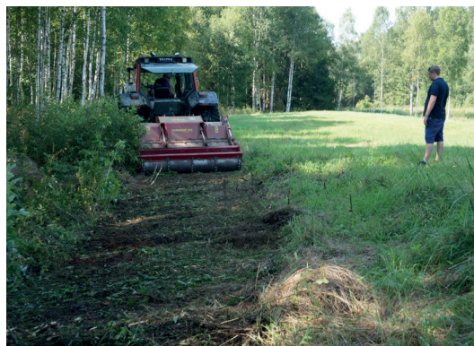
21.4.5. att. Krūmu sakņu frēzēšana Krustkalnu dabas rezervāta pļavā. Frēzes darbības princips ir līdzīgs 21.4.4. attēlā redzamajai frēzei, bet frēzes platums ir nedaudz lielāks. Šāda frēze vairāk piemērota minerālaugsnēm. Foto: A. Namatēva.
