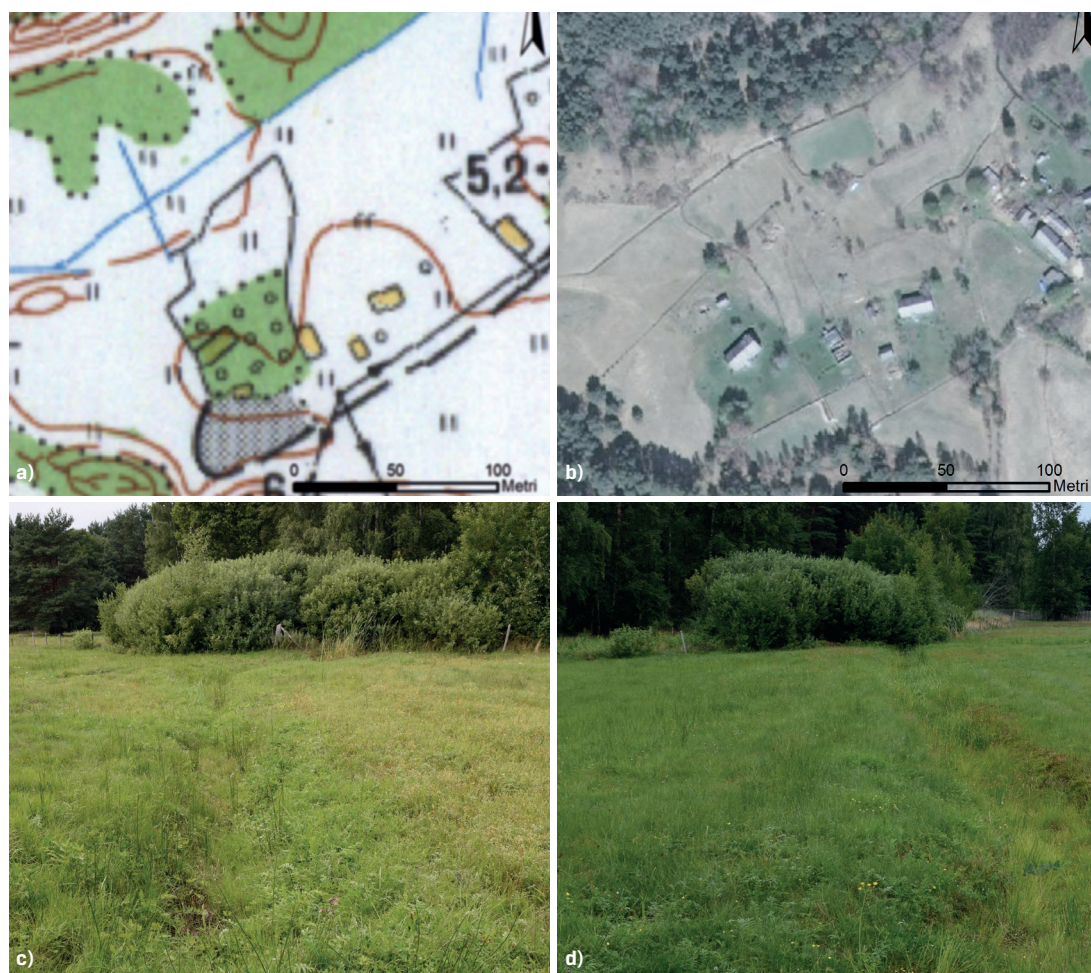
21.6.2. att. Seklu grāvju sistēma dabiskā zālājā Sikragā. (a) Grāvju sistēma topogrāfiskajā kartē, (b) grāvju sistēma ortofoto kartē, (c, d) – grāvji ir tik sekli un lēzeni, ka zāle tajos ir izplauta. Foto: S. Rūsiņa. Kartes: TOPO 10K PSRS; ortofoto karte mērogā 1 : 10 000 © Latvijas Ģeotelpiskās informācijas aģentūra (ORTOFOTO 4).
