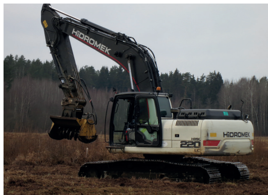
21.4.4. att. Krūmu sakņu frēzēšana ziemā sasaluma periodā Dvietes palieņu pļavās uz kūdras augsnes. Traktors aprīkots ar kāpurķēdēm, lai varētu pārvietoties pa mikstu, iegrimstošu virsu. Foto: S. Rūsiņa.
