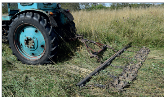
21.3.9. att. Pašdarināta šļūce, ar kuru var efektīvi nolidzināt kurmju un mežacūku rakumus, kā arī grišļu ciņus, ja to dara rudenī salnas laikā, kad ciņi trausli. Foto: S. Rūsiņa.
